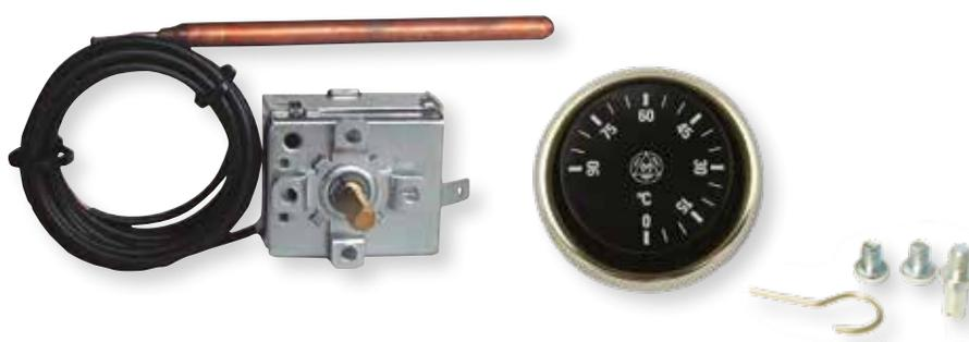
KIT TR2 comprende un TR2 con range di temperatura regolabile a 0 a 90°C, capillare 1500 PVC omologato INAIL, completo di manopola e ghiera.
