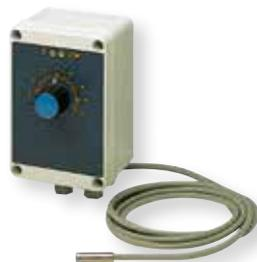
TAE/S è un termostato ambiente elettronico in contenitore stagno, a circuiti integrati con sensore di temperatura NTC a elevato grado di sensibilità. Provvisto di 2 LED di funzionamento: rosso (riscaldamento in funzione), verde (alimentazione). Adatto particolarmente per ambienti umidi e polverosi come serre, capannoni industriali, etc.
