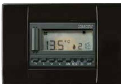
FAN 503 è un regolatore elettronico a incasso DIN503 per ventilconvettori, radiatori e ventilconvettori con display LCD. È completo di tre relè per regolare la velocità ventola e due relè per controllare le elettrovalvole e l'ingresso per la sonda acqua (sonda NTC 10K inclusa nella confezione).
